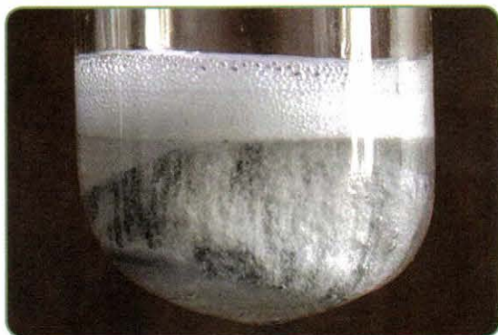
Рис. 32. Взаимодействие цинка с соляной кислотой
