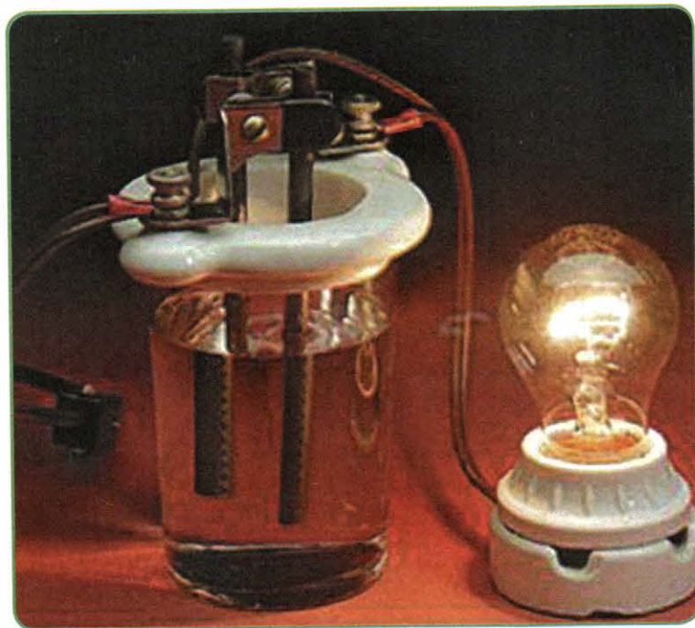
Рис. 58. Электролизёр — прибор для определения электропроводности растворов
