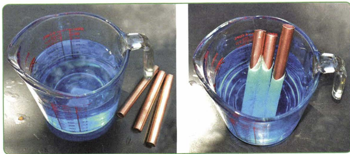
Рис. 61. Вытеснение серебра медью из раствора нитрата серебра
